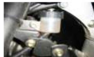
Se debe controlar constantemente el nivel del líquido de frenos ya que si existe una variación en el nivel del mismo se puede detectar con anticipación una fuga.
