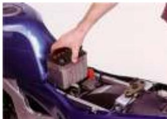
Las baterías sin mantenimiento no se pueden abrir fácilmente porque el proceso químico no es idéntico al de las baterías con mantenimiento. El agua necesaria para el proceso químico es generada con los elementos químicos de las placas. Por este motivo los vasos no necesitan agua y la batería no debe ser abierta.
