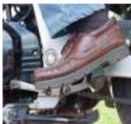
La posición correcta de los pies es aquella que nos permite accionar la palanca de cambios y el freno posterior sin necesidad de levantar el pie, teniéndolos sobre las estriberas y apoyándonos con la parte media de la planta
